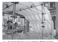
Abb. 4 Sperrholz-Prototyp einer gefalteten Plattenstruktur.
